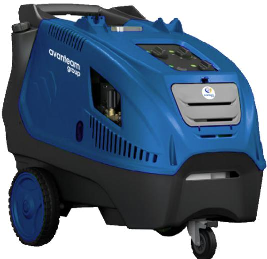
AQUATEAM EC 190-16 T 190 est le nettoyeur eau chaude triphasé professionnel de la gamme semi-intensive AVANTEAM le plus performant. Sa conception, trois pistons céramique associés à une culasse laiton, en fait un appareil idéal pour le professionnel.
