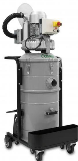
Cet aspirateur industriel triphasé est compact et polyvalent, idéal pour un usage intensif et l'aspiration des déchets liquides et solides en continu. Dôté d'une turbine à canal latéral triphasé et d'un système d'arrêt automatique, le A 104 OIL est ultra complet et très robuste.
